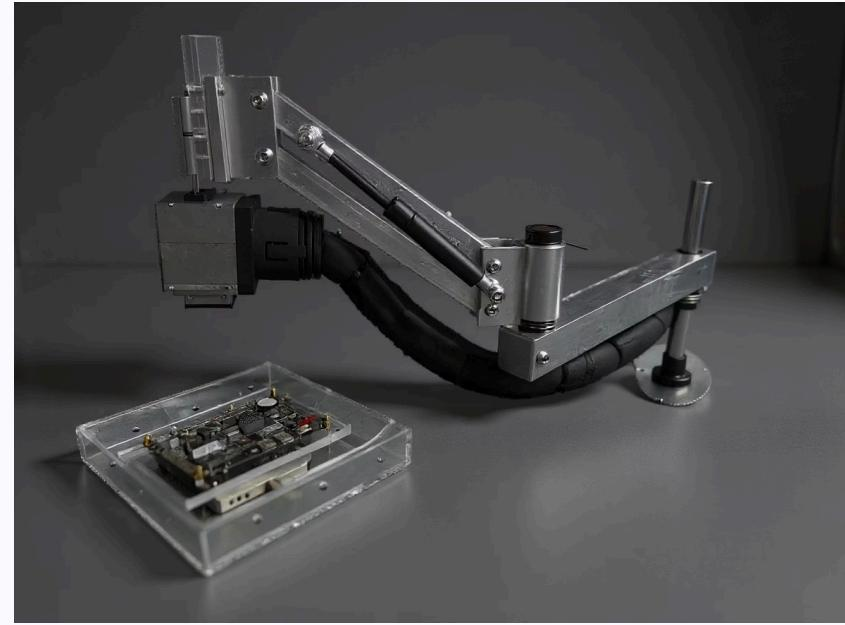
两种按压架均支持负载功能测试，可实时监测并记录压力数据，同步采集温度曲线，帮助工程师全面分析芯片在不同压力和温度条件下的性能表现，为产品设计和质量控制提供可靠依据。
